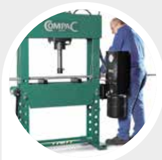
Pumpeenheden kan svinges 90 grader væk fra pressen.
