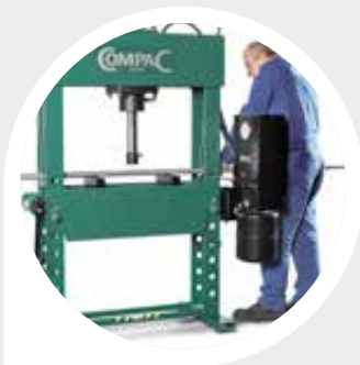
Pumpeenheden kan svinges 90 grader væk fra pressen.
